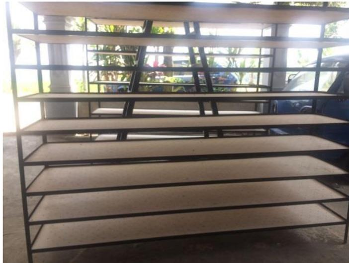
**Gambar 2. Desain rak fermentasi yang menggunakan bahan triplek dan didesain dengan lubang untuk sirkulasi udara selama fermentasi**
